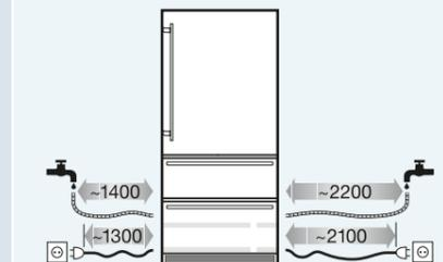
Include il tubo flessibile di 3m per allacciamento dell'IceMaker alla rete idrica (connessione 3/4")
