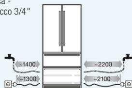
Include il tubo flessibile di 3m per allacciamento dell'IceMaker alla rete idrica (connessione 3/4")
